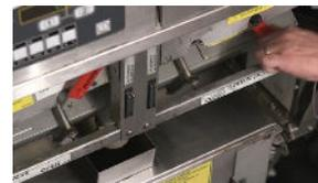
Válvula de Drenaje de la Freidora
